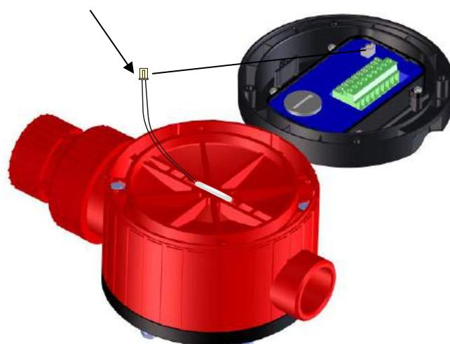
Die 4 Torx-Schrauben herausdrehen (Anzugsmoment max. 0,5 Nm).
