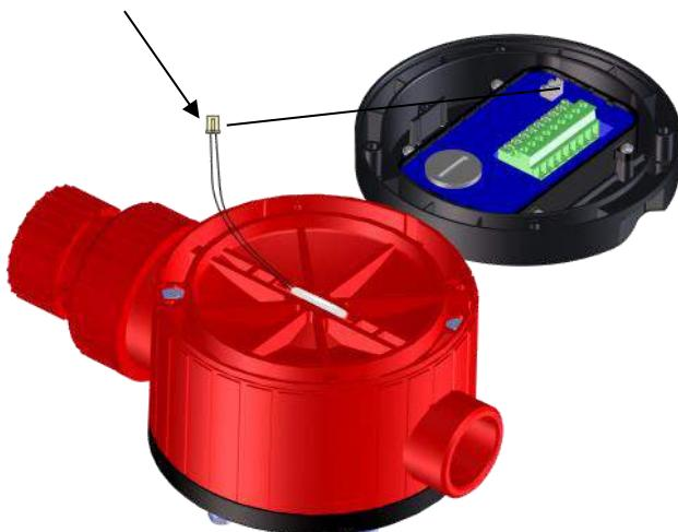
Retirer les 4 vis Torx (Couple de serrage max. 0,5 Nm)
