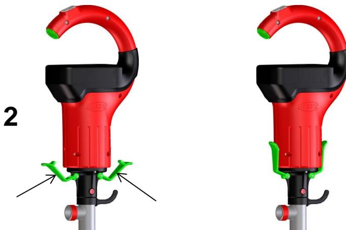
Die Spannhebel in Richtung Motor drücken, bis beide hörbar eingerastet sind.
